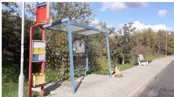
Takto vypadá efektivně zabezpečená zastávka. Nálepky jsou po celé ploše a zhruba 10 cm od sebe.
